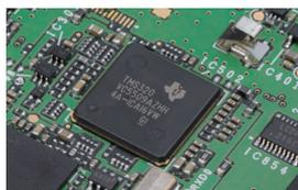
高音質設計にこだわり、AMBE+2™ ボコーダーを搭載したDSPを採用。また、DSP内部処理の最適化により、デジタル音声特有の「遅延」を最小限に抑制します。
